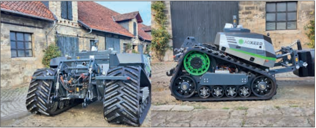
Kuva 1. AgBot -autonominen traktori saksalaisen kohtilan pihalla (takaa ja sivulta kuvattuna).
