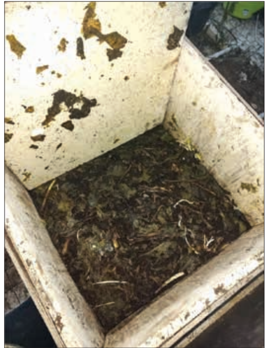
Kuva 4. Lämpö nousi 60 tilavuus-% naattisilppua sisältäneessä astiassa runsaassa viikossa 37 °C:een ja laski vähitellen noin 10 °C:een. Samalla naattisilppun rakenne muuttui, kun solurakenne hajosi ja vesi siirtyi turpeeseen.
