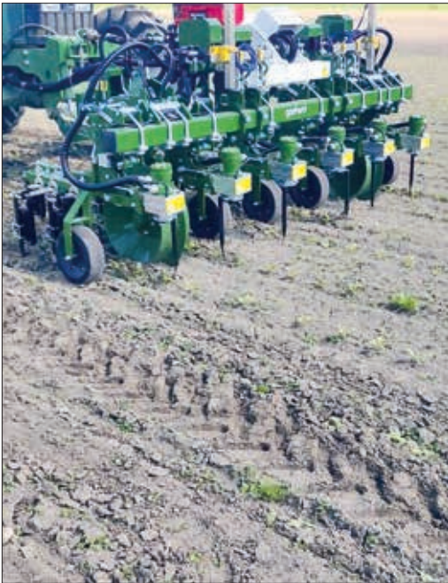
Kuva 1. Garfordin Robocrop inrow -hara.
