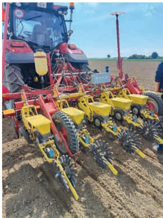
Tanskassa yleinen Kleinen kylvökone. Lannoitteiden hajalevitys näkyy kylvökoneiden lannoitesäiliön puuttumisena. Tässä koneessa traktorin edessä oli nestesäiliö, josta johdettiin nestemäistä lannoitetta sijoitettuna siemenrivin viereen.
