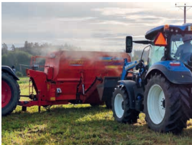
Kuva 2. Myös apevaunussa toteutetussa pikakompostoinnissa lämpötila nousi parhaimmillaan yli 60 °C.
